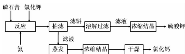
图1 磷石膏一步法制硫酸钾工艺流程
