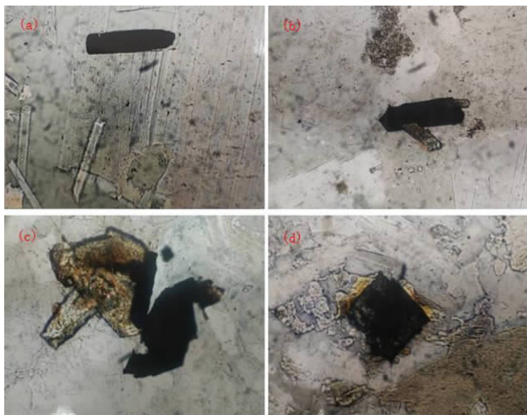
a - 柱状钽铌铁矿被包裹在铁锂云母中,横穿与铁锂云母解理缝垂直 b - 钽铌铁矿分布在斜长石与石英粒间 c - 柱状钽铌铁矿(暗色)与锡石连生(棕色),分布在斜长石粒间 d - 细晶石分布在斜长石与黄玉粒间(放大倍数160 偏光)
