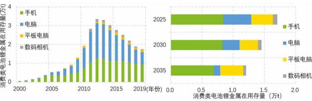
图 9 消费类电池锂金属存量预测 Fig. 9 Lithium metal in-use stock forecast for digital batteries
