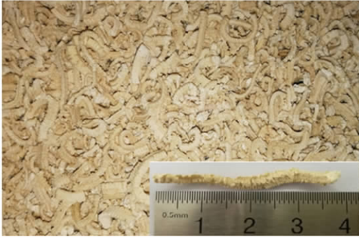
图8 高膨胀率膨胀蛭石的照片 Fig. 8 Photo of high expansion multiple expanded vermiculite Fig
