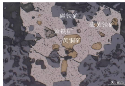
图 1 黄铜矿包裹于脉石矿物、黄铁矿和磁铁矿中 Fig. 1 Chalcopyrite encased in gangue minerals, pyrite and magnetite
