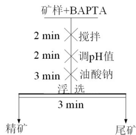
图 3 浮选试验流程 Fig. 3 Flotation process test
