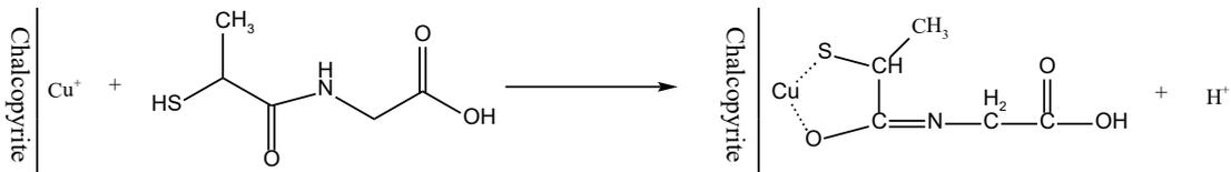
图 6 硫普罗宁在黄铜矿表面的吸附模型<sup>[66]</sup>
