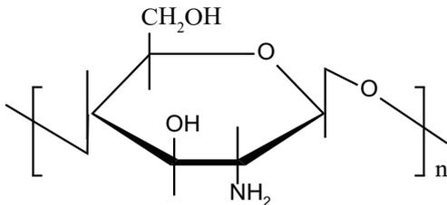
图 4 壳聚糖重复单元的结构<sup>[56]</sup>
