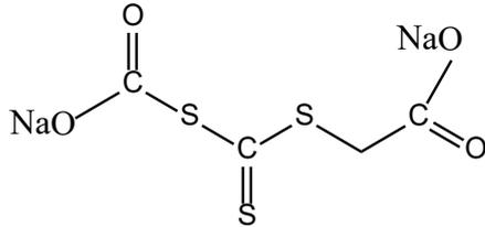
图 3 双(羧甲基)三硫代碳酸二钠的分子结构<sup>[62]</sup>
