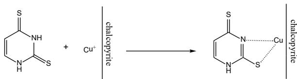
图 7 二硫脲嘧啶在黄铜矿表面的吸附模型<sup>[67]</sup>
