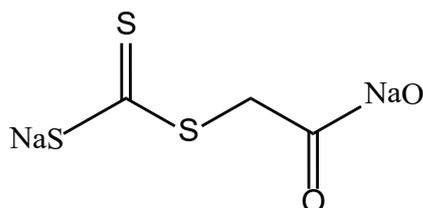
图 8 羧甲基三硫代碳酸二钠结构<sup>[69]</sup>
