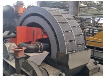
图 2 安装到位的改进后的内外双层分选环
