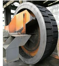
图 1 拆卸的原设备用单层环
